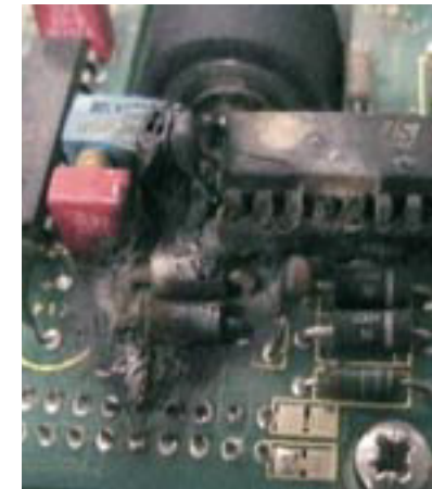
Schaden an Elektronik durch blitzbedingte Überspannungen
